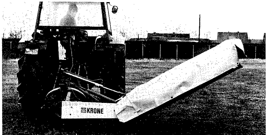
Einfaches Messerwechseln durch Messerschnellverschluss. Handhebel nach unten drehen und Messer wechseln.
