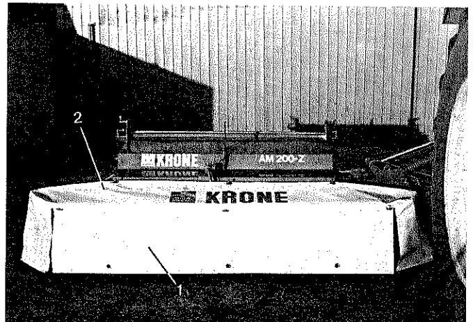
Schutz (1) mit eingeschobener Führungsleiste (2) montiert. Siehe Tafel 12.
